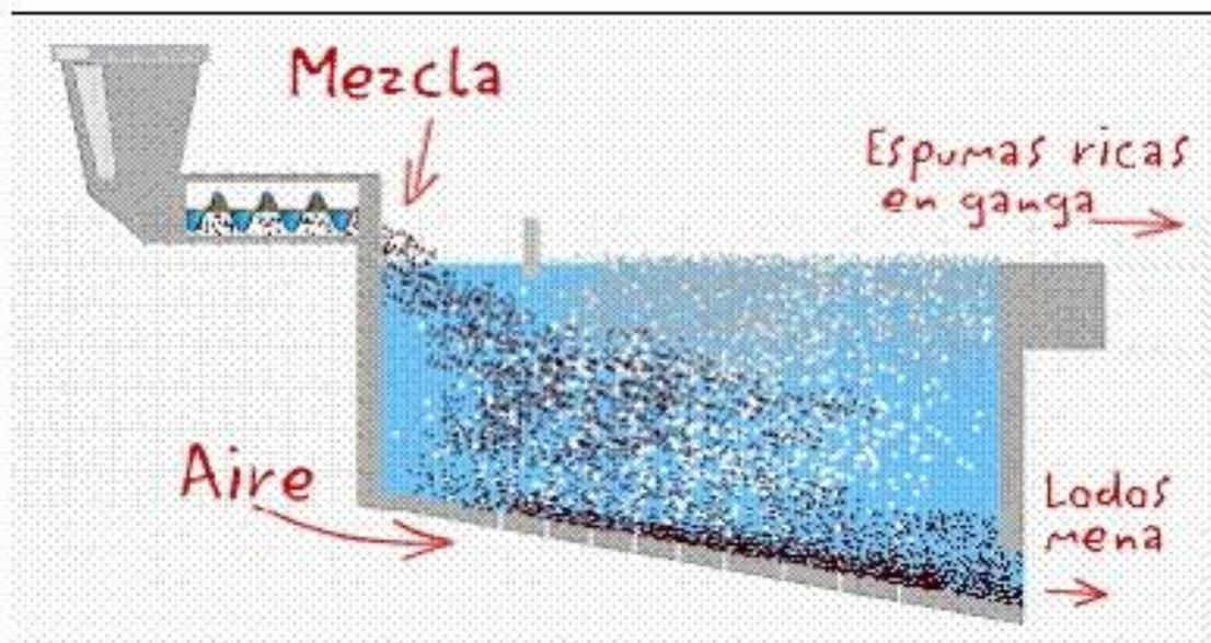
Imagen 14: Flotación. Fuente: Materiales virtuales ESPA LOE
