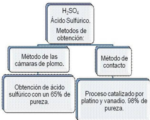
Imagen 17: Esquema de la obtención del ácido sulfúrico.
