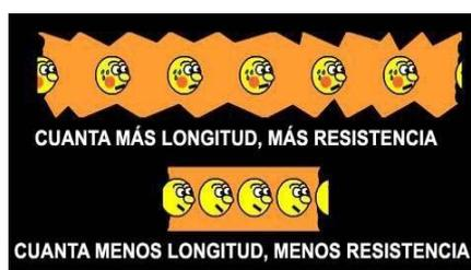
La resistencia se mide en una unidad llamada **ohmio** (que se simboliza con la letra griega omega mayúscula  $\Omega$ ). El aparato empleado para medirla se llama **ohmímetro**.
